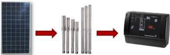
1. แผงเซลล์แสงอาทิตย์ 2. เครื่องสูบน้ำ 3. อุปกรณ์ควบคุม
